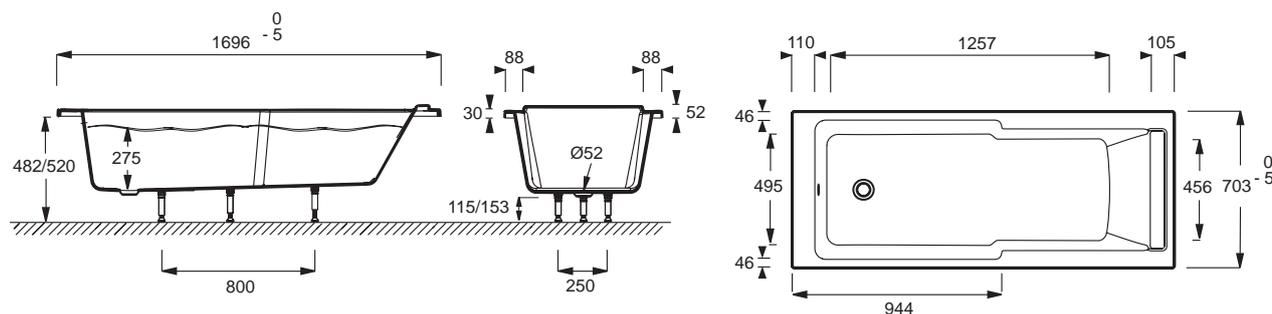
Спецификация продукта: Ванна 170 x 70 см для установки с каркасом. E6D020RU. Коллекция: СТРУКТУРА. РАЗМЕРЫ (СМ): 170 x 70 см. МАТЕРИАЛ: Акрил. ТИП УСТАНОВКИ: Встраиваемые. ОБЪЕМ: 192/122. ФОРМА: Прямоугольные.
