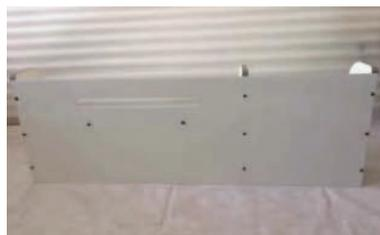
3. Используйте 11 винтов (M5\*30), чтобы установить железную заднюю пластину на заднюю часть описанных выше комплектующих.
