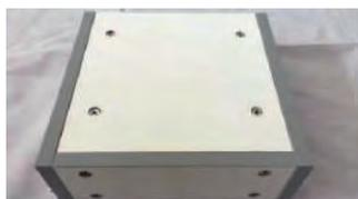
3. Используйте 4 гайки (3 в 1), чтобы соединить переднюю, а также левую и правую боковые панели тумбы вместе.
