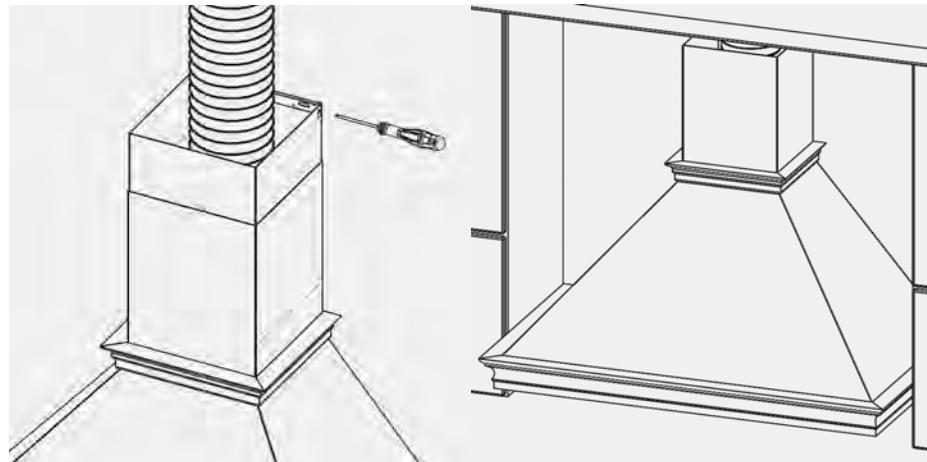
1. Вставьте внутреннюю часть телескопического короба во внешнюю. Закрепите внешнюю часть короба к корпусу вытяжки.
