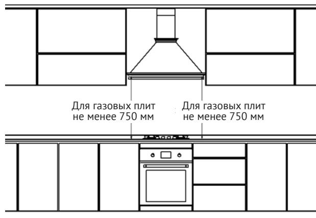
При наличии в комнате печи, газового котла или колонки необходимо учитывать, что во время работы вытяжка забирает из помещения воздух, необходимый для горения. Это относится также к помещению с герметичными окнами и дверями.
