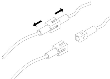
Отсоедините светодиодную лампу, нажав на соединение, указанное стрелками. Установите новую лампу освещения. Проверьте, работают ли лампы освещения.
