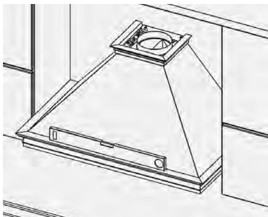
**3.** С помощью гибкой трубы соответствующего диаметра (предпочтительно 120-150 мм), наличие которой должен обеспечить пользователь, соединить трубу, идущую в комплекте с устройством, с редукторным переходником и заслонкой (диаметр 120-150 мм), другой конец вывести наружу/ присоединить к вентиляционной трубе (если таковая имеется).
