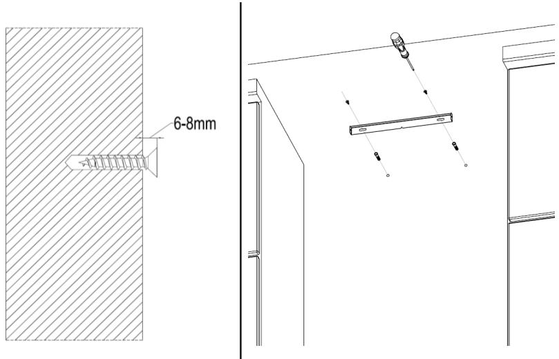
2. Установите вытяжку на место и зафиксируйте ее при помощи винтов.
