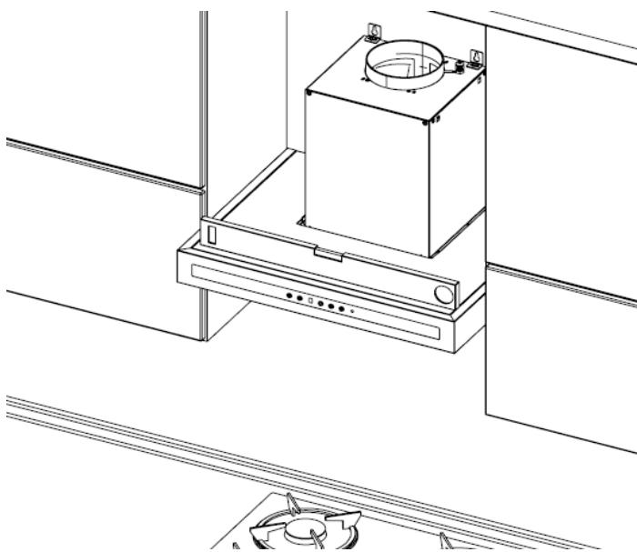
**3.** С помощью гибкой трубы соответствующего диаметра (предпочтительно 120-150 мм), наличие которой должен обеспечить пользователь, соединить трубу, идущую в комплекте с устройством, с редукторным переходником и заслонкой (диаметр 120-150 мм), другой конец вывести наружу/присоединить к вентиляционной трубе (если таковая имеется).
