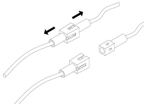
Отсоедините светодиодную лампу, нажав на соединение, указанное стрелками. Установите новую лампу освещения. Проверьте, работают ли лампы освещения.
