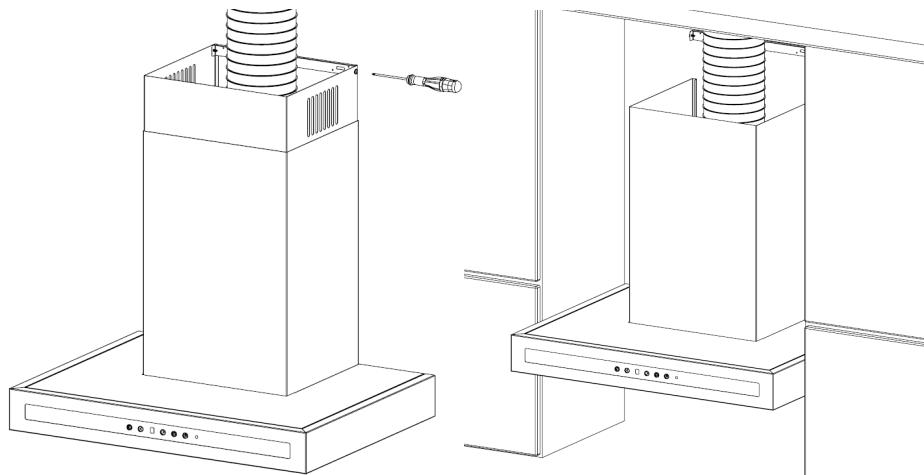
**1.** Вставьте внутреннюю часть телескопического короба во внешнюю. Закрепите внешнюю часть короба к корпусу вытяжки.
