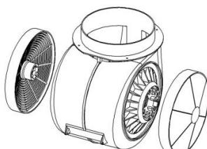
Угольные фильтры, предназначенные для использования вытяжки в режиме рециркуляции воздуха и могут применяться в зависимости от серии и типа вытяжки. Угольные фильтры необходимо менять на новые через 3-6 месяцев использования, в зависимости от частоты приготовления пищи.
