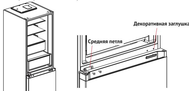
Извлеките из установочного комплекта левую петлю и её декоративную заглушку. Установите дверь холодильной камеры на среднюю петлю, затем установите верхнюю левую петлю, тем самым зафиксировав дверь холодильной камеры. Подключите клемму 4 к клемме 1 и клемму 3 к клемме 2. Установите декоративную крышку на правую сторону, тем самым закрыв клеммы 2 и 3 (при установке на правую сторону, необходимо удалить две направляющие, установленные с внутренней стороны декоративной крышки).
