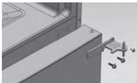
б) Поднимите дверцу морозильной камеры примерно на 50 мм, чтобы ее можно было снять.
