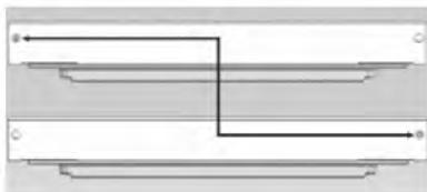
б) Снимите винты со стопора, как показано на следующем рисунке, и установите его на противоположной стороне двери.
