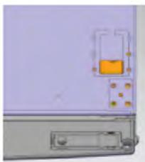
г) Ослабьте 1 винт, как показано на рисунке ниже, чтобы снять заглушку на верхней стороне прибора. Снимите маленькую торцевую заглушку на дверце и извлеките дверную втулку и кабельное соединение.
