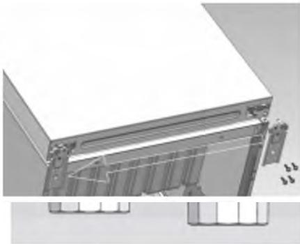
с) Установите заглушку на противоположной стороне прибора и затяните винт.
