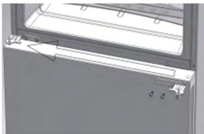
б) Прикрепите дверцу холодильника и установите верхнюю петлю на противоположной стороне прибора.
