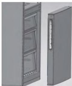
с) Снимите регулируемые передние ножки под нижней петлей. Затем ослабьте 4 винта, удерживающих нижнюю петлю, и снимите ее с холодильника.
