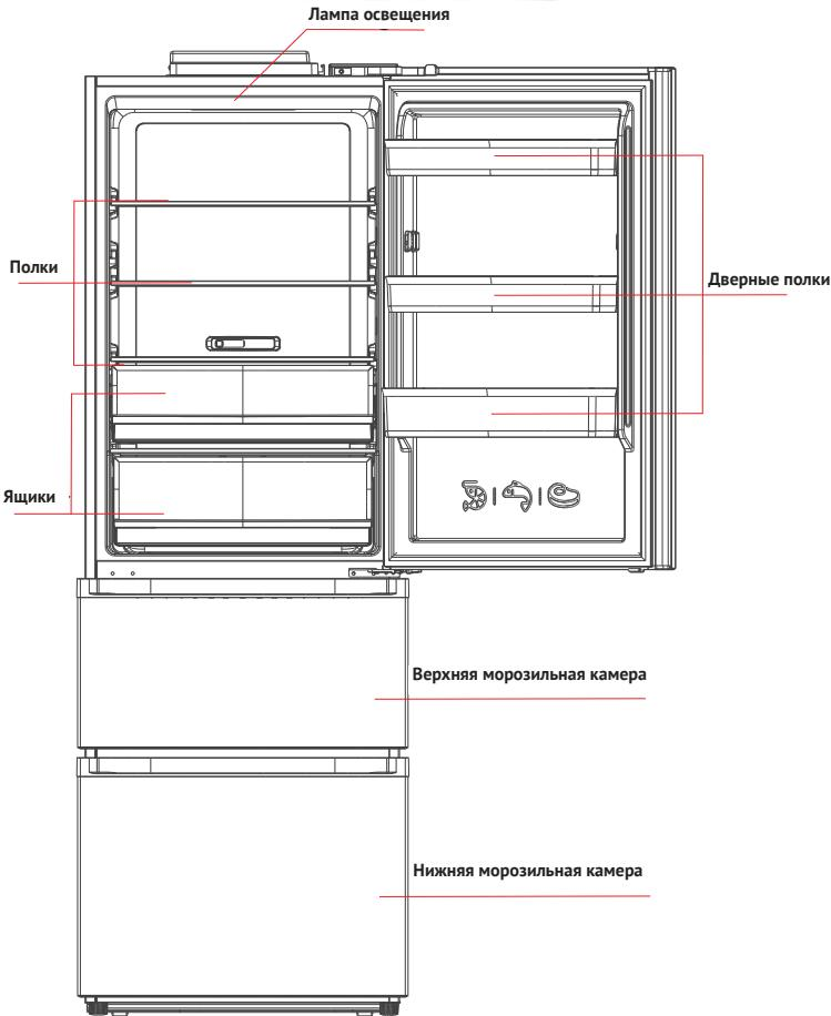
(Изображение имеет справочный характер и может отличаться в зависимости от модификации)
