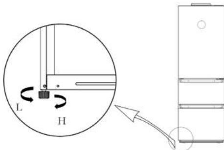
Если холодильник установлен не по уровню, дверь и магнитные уплотнители будут закрываться неплотно.
