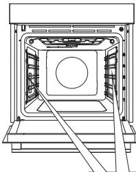
**A** Приподнимите направляющие снизу и отведите от стенки духовки.
