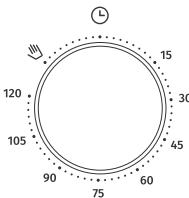
**ТАЙМЕР ОТКЛЮЧЕНИЯ** (реле времени). Сначала установите режим и температуру приготовления. Установите время таймера, вращая переключатель таймера по часовой стрелке. По истечении установленного времени выбранный режим нагрева отключается.
