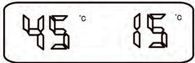
Слева отражена температура нагрева, справа – текущая температура воды в отсеке
