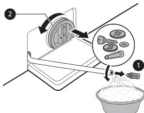
**4** После завершения очистки фильтра сливного насоса осторожно установите фильтр на место и снова заверните крышку сливного отверстия по часовой стрелке так, чтобы исключить заедание резьбы и утечку жидкости. Снова установите заглушку в сливную трубку и поместите трубку в соответствующий держатель.
