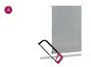
При помощи ножовки обрезать трубу: труба должна быть длиннее ширины ткани на 3 мм
