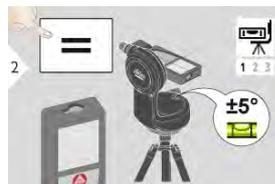
Для выполнения выравнивания диапазон наклона прибора должен составлять  $\pm 5^\circ$ .
