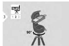
Поверните прибор по направлению движения часовой стрелки на  $90^\circ$ . Следуйте инструкциям на дисплее.
