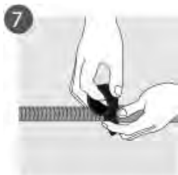
7 Соедините дренажный трубопровод
