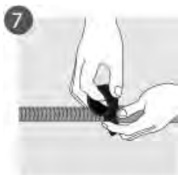
7 Соедините дренажный трубопровод
