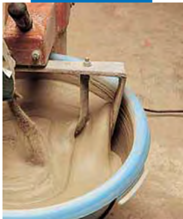
Смешивание серого Planiseal 88 с водой
