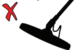
Неправильный угол наклона поисковой катушки
