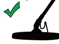
Правильный угол наклона поисковой катушки
