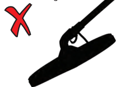
Неправильный угол наклона поисковой катушки
