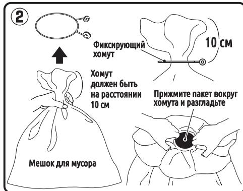
Наполните мешок воздухом, возмитесь за горлышко пакета и установите фиксирующий хомут, затем оберните пакет вокруг хомута и разгладьте, удерживая уровень горловины пакета на расстоянии 10 см.
