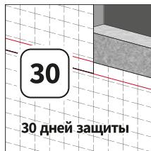
**10.** Плёнка может служить защитой утеплителя на стенах в течение **30 дней** до монтажа наружной отделки. Пленка сыртқы әрлеуді монтаждағанда дейін 30 күн бойы қабырғаларда жылытықшты қорғау қызметін атқаруы мүмкін.
