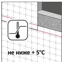
**9.** Монтаж рекомендуется выполнять при температуре **не ниже +5°C**. Монтаждауды +5°C төмен емес температурада орындау үсынылады.
