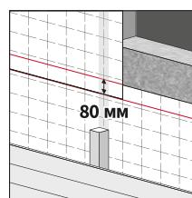
**2. Со стороны улицы монтаж выполняется логотипом и разметкой наружу. Внутри помещений – логотипом и разметкой в сторону помещения. Монтаж ведётся горизонтальными полотнами снизу вверх **с нахлестом 80 мм** (указан линией).**
