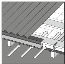
**9.** На утеплённой кровле с водосточной системой отверстия для впуска воздуха должны располагаться ниже водосточного желоба. Не заводите мембрану в водосточный желоб. Суағар жүйесі бар жылтылған шатырда ауажіберуге арналған тесіктер суағар науасынан төмен орналасуы тиіс. Мембранныи қоқыс жәшігіне салмаңыз.
