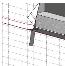
**5. Для уменьшения теплопотерь, связанных с проникновением холодного внешнего воздуха, все стыки полотен должны тщательно герметизироваться. На лицевой стороне полотна нанесена специальная монтажная лента. На обратной стороне прозрачная лента – основа для приклеивания.**
