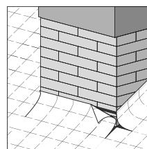
**6. Для приклеивания плёнки к конструктивным элементам здания, а также воздуховодам, вентиляционным и печным трубам применяется бутилкаучуковая монтажная лента ONDUTISS Butyl Tape.**
