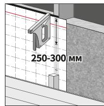
**4. Крепление плёнки выполняется при помощи строительного степлера **с шагом 250–300 мм**. После чего устанавливаются бруски для обеспечения зазора и крепления отделки.**
