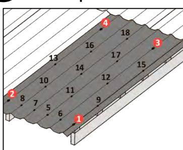
18 гвоздей на лист сначала по углам, потом в каждую волну по нижнему краю листа, потом в шахматном порядке через волну в промежуточных линиях. Забивать гвоздь вертикально, в верх волны в нанесённые отметки.
