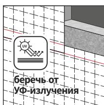
**1. Плёнка предназначена исключительно для использования внутри помещения и не должна подвергаться воздействию УФ-излучения во время монтажа и эксплуатации!**
