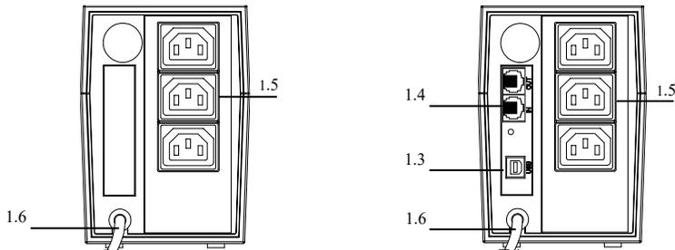
Задняя панель модели с входным плавким предохранителем (опционально)
