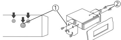
2. Закрепите кронштейны с обеих сторон устройства не менее чем в двух местах. Для этого используйте либо крепежные винты (5 x 6 мм), либо винты с потайной головкой (4 x 6 мм), в зависимости от типа резьбовых отверстий на кронштейне.
