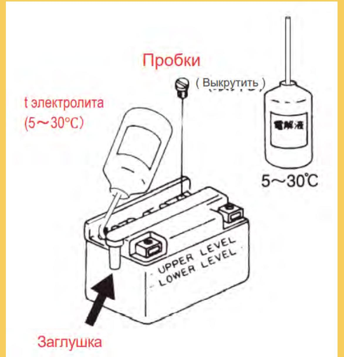
1. Выкрутить пробки и снять заглушку при наличии.
