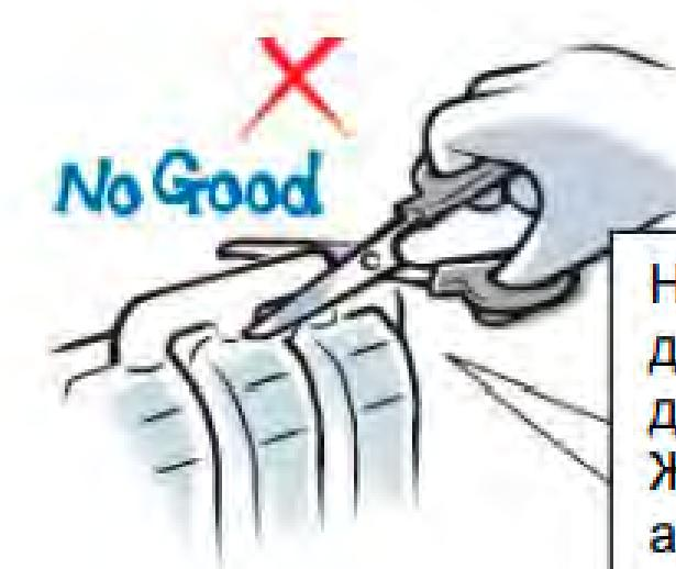
Не отрезать (не протыкать) дно ёмкости электролита для ускорения заливки. Жидкость должна поступать в аккумулятор неспешно и естественным путем.
