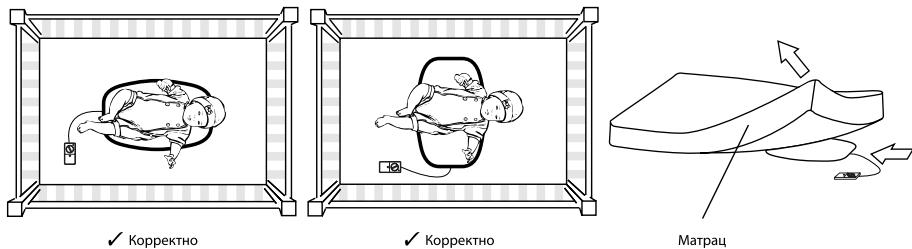
8.4.2. В то время как ребенок находится в кроватке, включите монитор движения, повернув реле настройки чувствительности (28) по часовой стрелке. Отрегулируйте положение реле (28) так, чтобы индикатор движения (27) начал мигать в ритме с дыханием ребенка.
