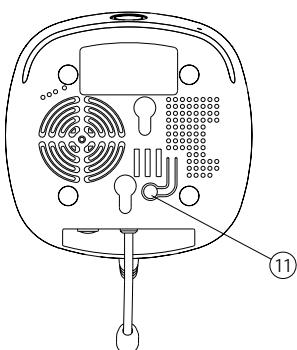
Если соединение не произошло, и на экране монитора происходит обратный отсчет времени, повторно нажмите кнопку соединения на камере (11) или повторите шаги согласно пунктам 4.1.1 - 4.1.6.
