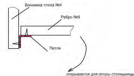
Схема крепления картонной петли к боковине №4 и ребро №9 ВИД СВЕРХУ - Закрытое положение
