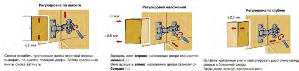
Рис. 3 Схема установки петель
