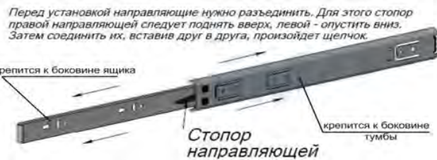
Рис.4 Схема установки шариковых направляющих
