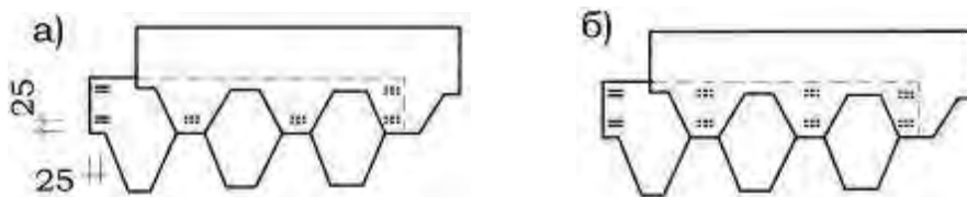
Рисунок 5.5. Схема крепления черепицы “Standart” скобами на кровле с уклоном до 45° (а) и с уклоном более 45° (б).
