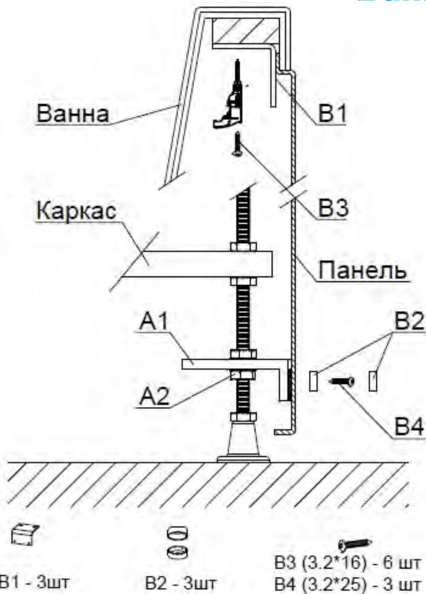
Приложите панель к ванне и отрегулируйте при помощи гаек А2 положение нижнего крепления панели А1 (входят в комплект каркаса). Зафиксируйте уголок В1 к закладным (на внутренней стороне борта) обеспечив зазор на толщину панели между бортом и уголком. Поставив панель на ванну, как показано на кртиинке, зафиксируйте нижнюю часть панели шурупом В4 через основание заглушки В2. Установите декоративную заглушку на основание.
