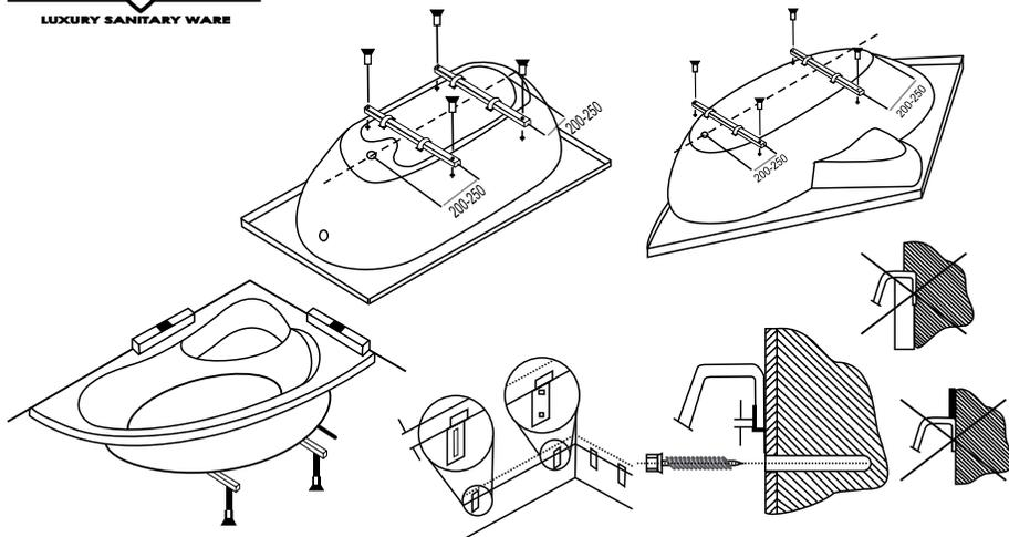
Отрегулировать положение ванны исключающее образование не сливаемых объемов воды при сливе ванны.
