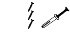
Саморезы 3,5x25 или дюбель-гвоздь 6x40 (в зависимости от поверхности) Self-tapping screws 3,5x25 or nail dowels 6x40 (depending on the surface)
