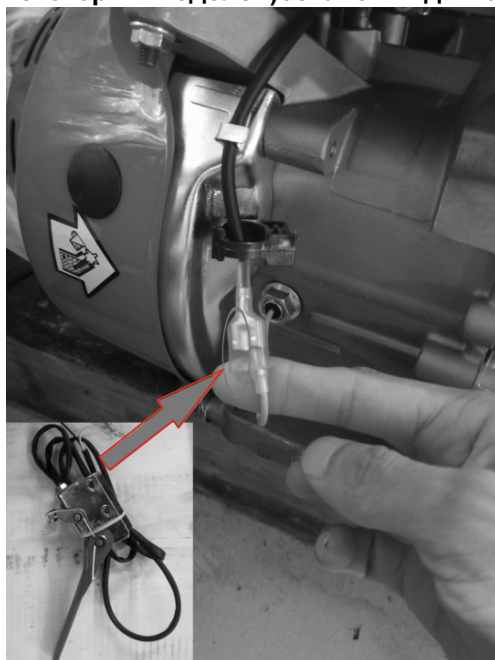
Схема подключения ручки(либо кнопки для некоторых моделей)остановки двигателя
