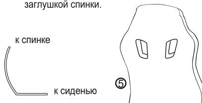
3. Наживите крестовой отвёрткой Ph3 кронштейн спинки ⑤ к сиденью ⑥ четырьмя винтами M6x25мм через отверстия в металлической площадке. Затяните все винты крепления кронштейна спинки и металлической площадки ④.
