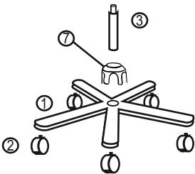
3. Сиденье установите отверстием в механизм ④ на газлифт ③
