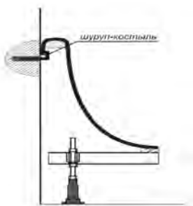
Рис. 2. Установка ванны на скобы.
