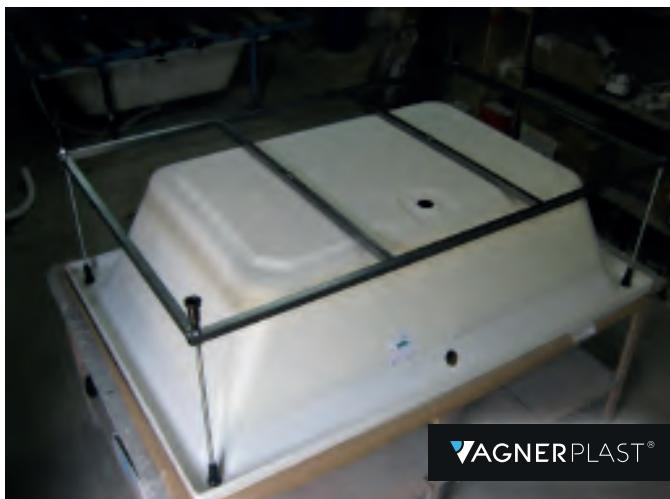
⑩ В гайки, приваренные к каркасу, вкручиваются короткие шпильки с гайкой и ножкой
