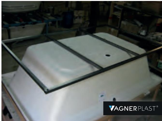
② В угловые отверстия каркаса продеваются шпильки с накрученными на них двумя гайками и ножкой
