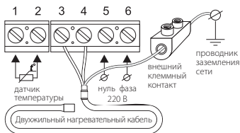
Схема подключения к 3-х проводной электрической сети
