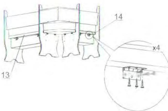
Установите угловое сидение на уголки металлические, закрепите при помощи шурупов 4x16.
