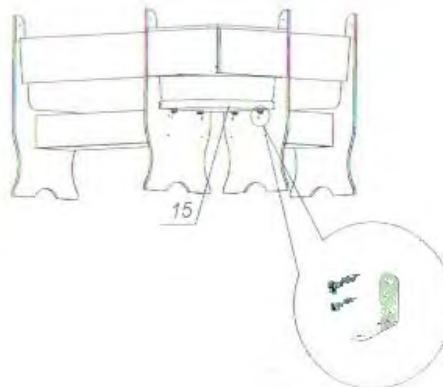
Уголки металлические для крепления углового сидения на боковых стенках №2, №3 крепятся как показано на рис.
