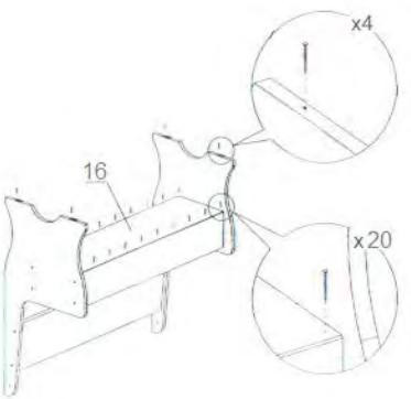
Соедините угловую секцию с собранными скамьями при помощи стяжки 7\*50 и ключа-конфирматка.
