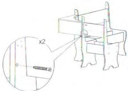
Далее произведите установку мягких сидений. Для этого по наметкам на царгах ящика №7, №9 и сидений с мягким элементом №13 и №14 установите петлю форточную при помощи шурупов 4x16.
