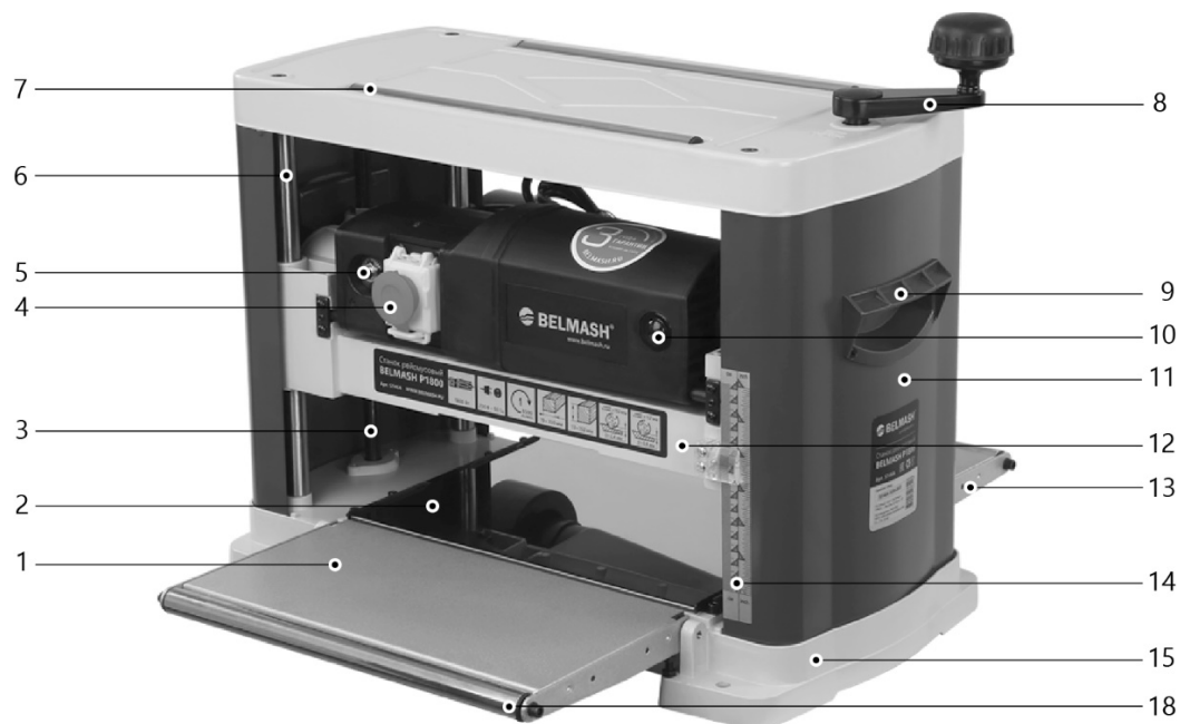
Рисунок 1. Основные элементы станка BELMASH P1800
