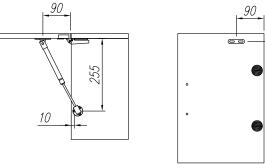
Схема монтажа крепежных планок газлифта на Боковину корпуса и Фасад. Более точная схема для определенного типа газлифта изображена на его упаковке.
