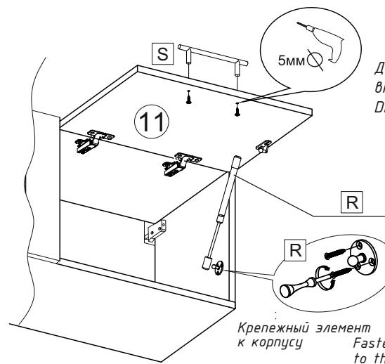
Регулировка петель / Sash loop adjustment
