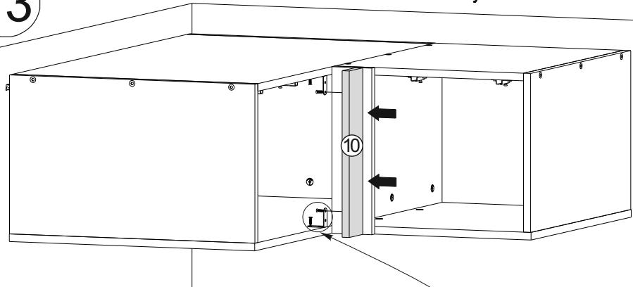
*Стыковка планок/Connecting the slats*
