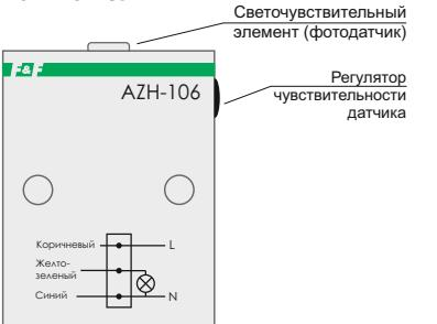
Автомат светочувствительный AZH-106 выполнен в корпусе А8 для крепления на плоскость. С правой стороны от лицевой панели находится регулятор чувствительности датчика. Сверху от лицевой панели находится светочувствительный элемент (фотодатчик).
