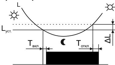
Lуст – установленный порог срабатывания;
