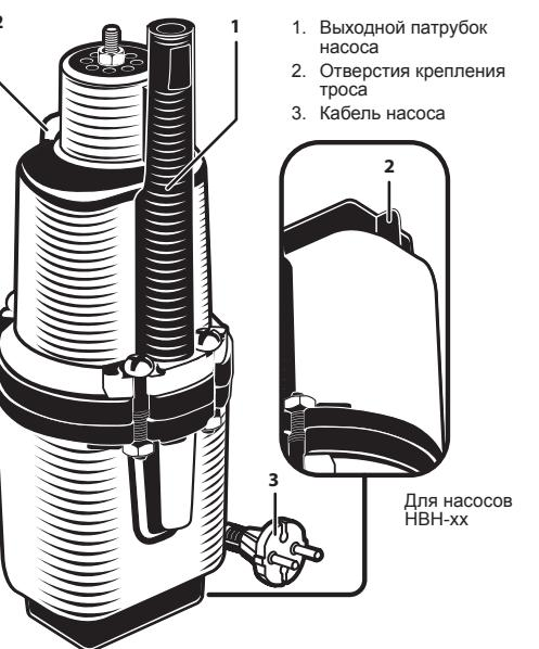
**ПРИМЕЧАНИЕ!** При всех видах монтажа насос должен быть погружен в воду на глубину не более 3 метров.
