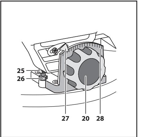
Ослабьте винт фиксации наклона пилы 20, приведите голову в вертикальное положение, ослабьте стопорную гайку 26 болта 25 и, используя угольник, вращением болта 25 установите пильный диск на угол 90° относительно стола 13. Затяните стопорную гайку 26.
