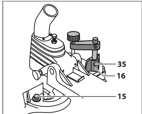
Для надежной фиксации заготовки при пилении на фронтальном упоре 2 предусмотрены гнезда 16 для крепления струбцины (в комплекте – только у ЗПТ-255-1800 лм2). Вставьте стержень струбцины в гнездо и затяните винт 35 на задней стороне гнезда для закрепления стержня. Отрегулируйте струбцину в соответствии с размером и формой заготовки. Струбцина может быть установлена в упоре как слева, так и справа от пильного диска.
