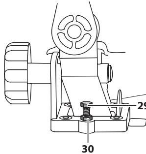
Ослабьте винт фиксации наклона пилы **20**, приведите голову в крайнее наклонное положение, ослабьте стопорную гайку **30** и вращением болта **29** установите, используя угломер, пильный диск **3** на угол 45° относительно стола **13**. Затяните стопорную гайку **30**.
