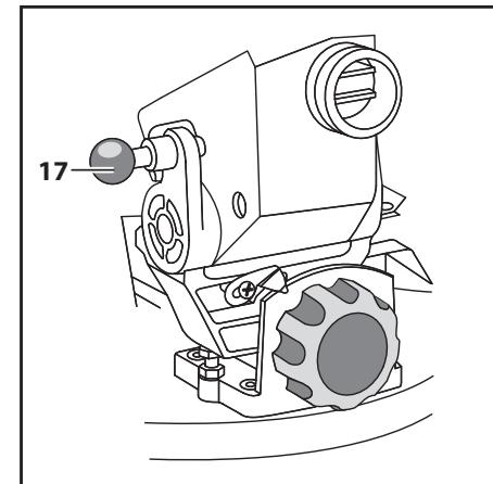
Приведите изделие в рабочее положение, для чего приопустите голову за рукоятку 8 и извлеките стопорную шпильку 17. Придерживая рукоятку 8, дайте головке возможность под действием пружины переместиться в верхнее положение.
