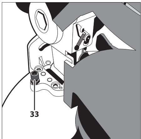
в) Регулировка угла 90° при торцевом пиления
