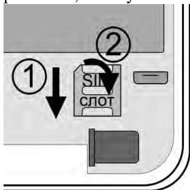
3. Установите Sim-карту в слот и закройте его крышку, сдвинув её вверх:
