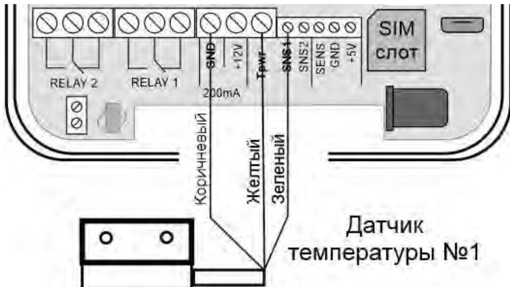
Если датчик температуры отключен, подключите его согласно схеме, выше.
