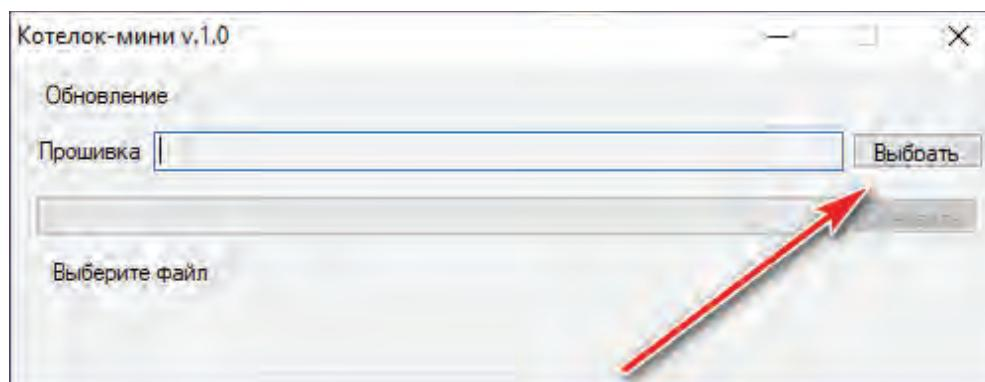
4. Появится меню выбора файла прошивки. Выбираем файл прошивки для прибора в формате «.hex» и нажимаем открыть.
