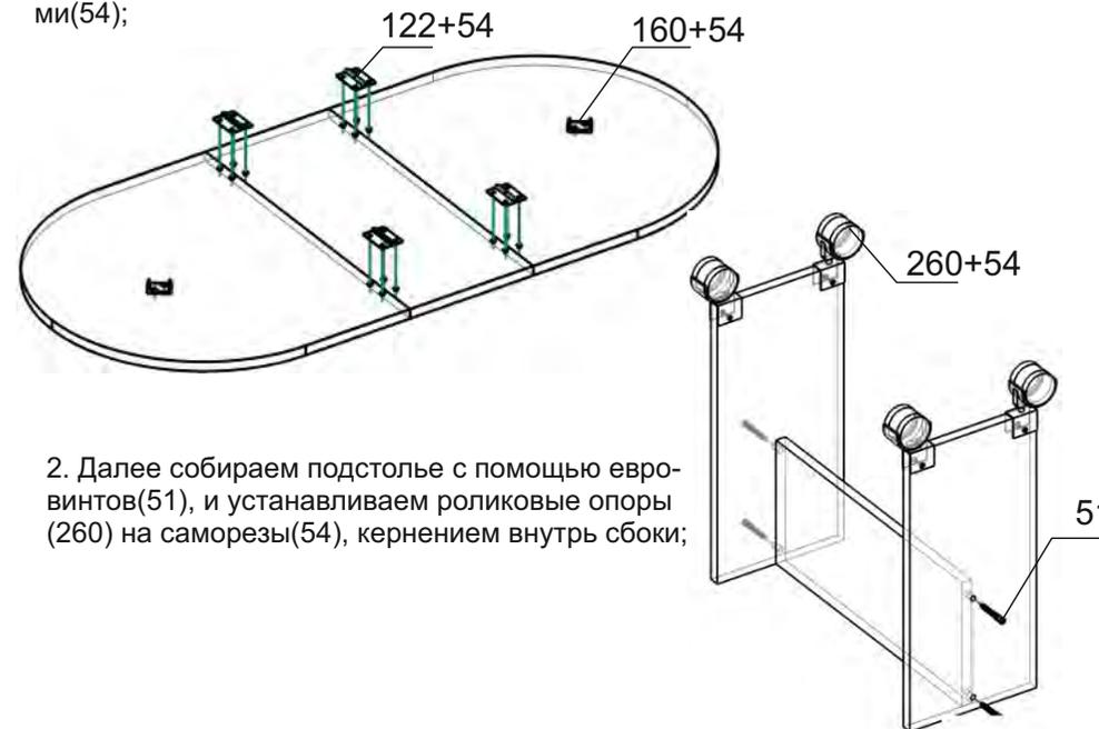
2. Далее собираем подстолье с помощью евровинтов(51), и устанавливаем роликовые опоры (260) на саморезы(54), кернением внутрь боки;
