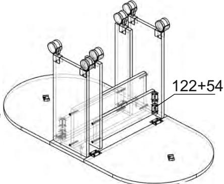
5. Закрепляем выдвижные опоры на подстолье петлями(122) на саморезы(54). Установить заглушки на евроинты(56);
