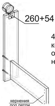
4. Собираем выдвижные опоры(2шт.) на евроинты(51) так, чтобы керна для петель располагались как на эскизе, керна для опоры располагаем внутри. Устанавливаем опоры роликовые(260) на саморезы черные(54)
