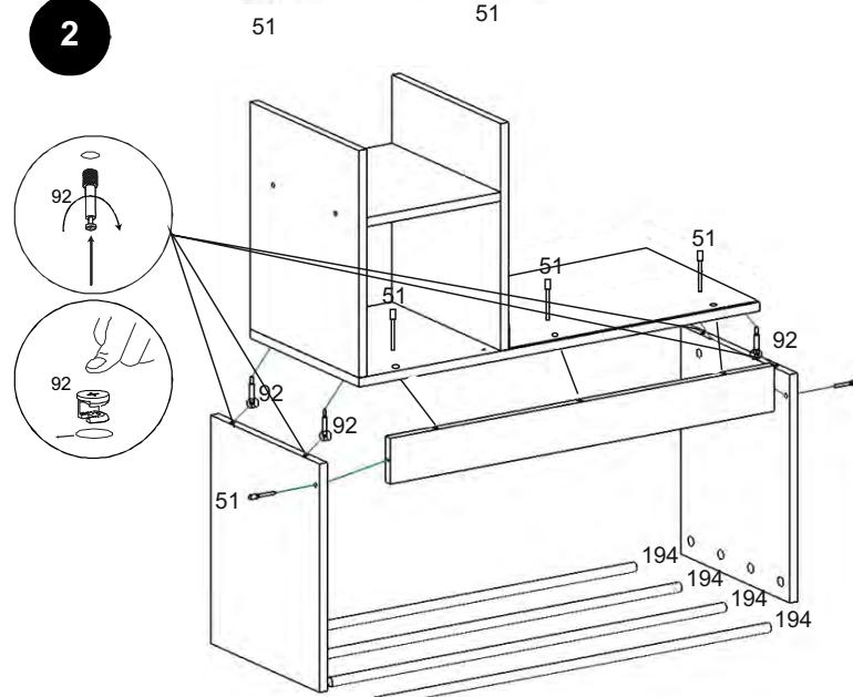
2. С нижней части горизонтального щита в глухие отверстия закрутить стойку эксцентриковой стяжки 92, в боках 2, 3 вставьте эксцентрик бочонок 92 стрелкой вверх, затяните вращая эксцентрик по часовой стрелке.
